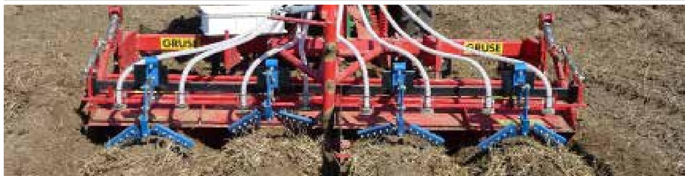
Bild 1: Mechanisches Dammergerät mit pneumatischer Säeinheit zur Zwischenfruchtaussaat
